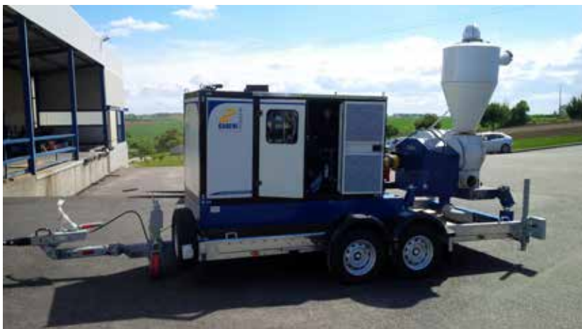
Grain transfer suction blower Aspirateur et souffleur par vide pour transfert de céréales
